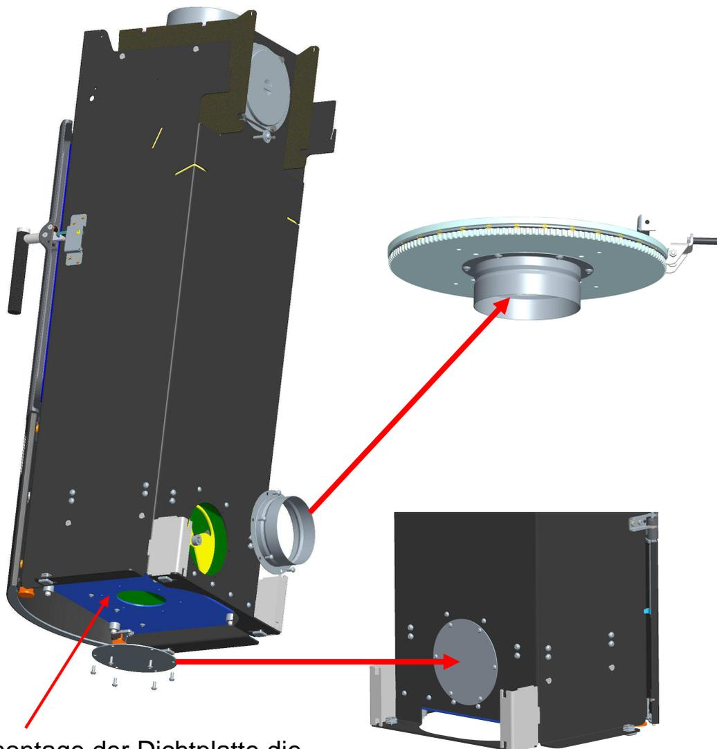
Nach Demontage der Dichtplatte die Gewindelöcher im Boden mit Silikon abdichten (6x)
